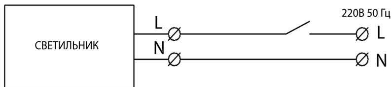
Рисунок 3 Схема подключения светильника
